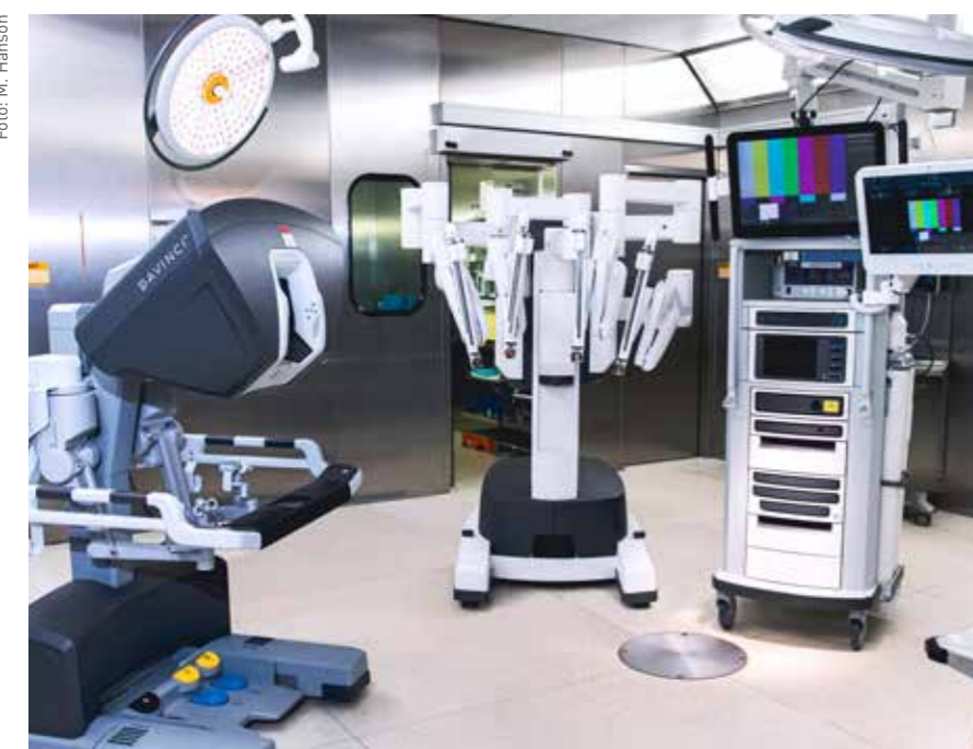
Mit dem roboterassistierten DaVinci® Roboter-System können minimalinvasive Eingriffe durchgeführt werden. Eine zehnfache Vergrößerung des 3D-Kamerasystems stellt Nerven und Gefäße genau dar.
